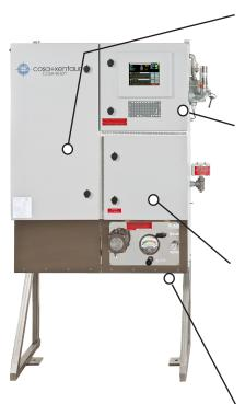
气体混合室包含样品预处理和气体混合系统。气体混合室被加热以避免较重的气体成分凝结。样品室中的所有电气组件均达到危险区域等级。
